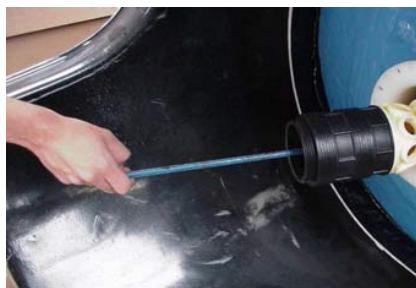
2: Les pièces sont assemblées (à l'extérieur de la bouteille) et introduites en utilisant l'extension I-WR03-LA
