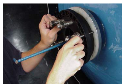
Stap 6: Gebruik de flens om het verdeelsysteem op de 6" flens aan te sluiten. Neem nu de extensie weg.
