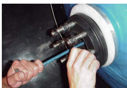
Stap 5: Schroef de flensadapter op de gemonteerde assemblage. Controleer of de O-ring goed op de adapter aangebracht is en een goede afdichting vormt.
