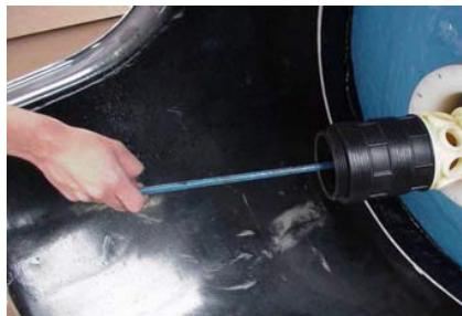
Fase 2: I pezzi mostrati nella fase 1 sono assemblati (all'esterno del serbatoio) e inseriti nel serbatoio attraverso l'estensione I-WR03-LA.
