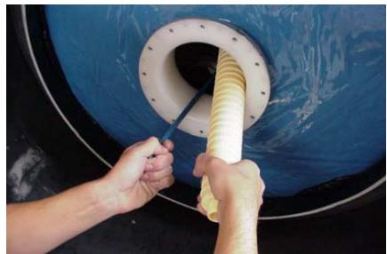
Fase 3: Mettere il gruppo all'interno del serbatoio per montare i laterali.
